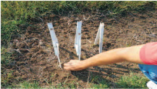
Termómetros de suelo (indican temperatura y humedad a diferentes profundidades)
